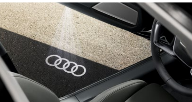
De instap-led projecteert de Audi-ringen op de bodem bij het openen van de voorportieren.
